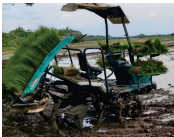
Figura 1. Máquina trasplantadora de arroz Kubota SPV-6CMD en proceso
