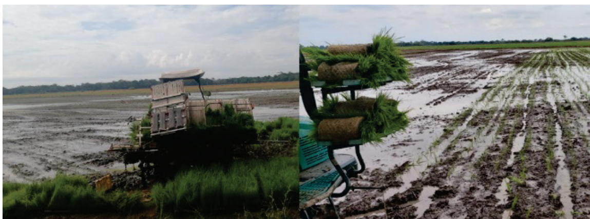
Figura 6. Proceso de trasplante mecanizado de arroz de semilleros a lote
